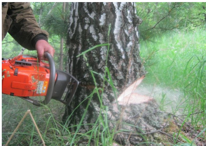
Рис. 27 Выполнив подпил, вальщик начинает выполнять перепил
