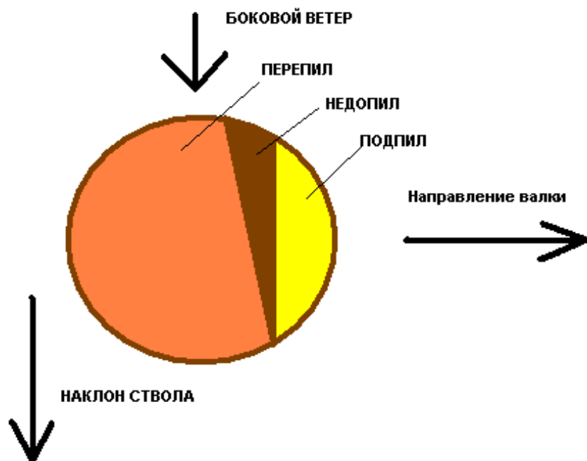
Рис. Недопил клиновидной формы позволяет осуществить валку в заданном направлении вопреки наклону ствола или боковому ветру
